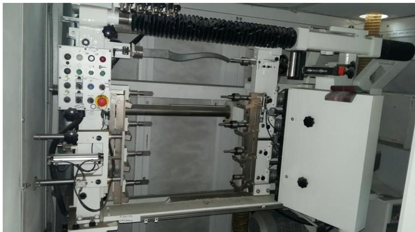
Токарно-шлифовальный центр Т4М-О предназначен для обработки заготовок сложной формы, которые могут быть составными частями различных предметов мебели и обихода. Жесткая чугунная рама и продуманная конструкция станка позволяют избежать вибраций даже на высоких скоростях обработки при снятии большого количества материала. Со специальным приспособлением для центровки деталей переустановка заготовок занимает малое время.
